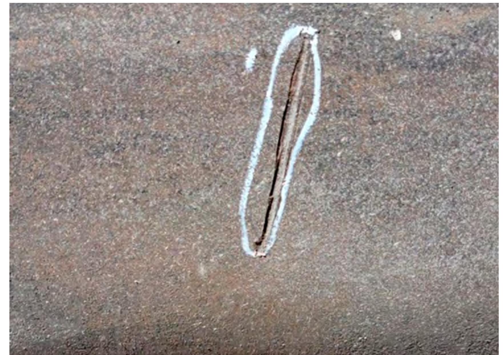
11. attēls. Cauruļvada tipveida defekts – skramba. Radies būvniecības laikā.
